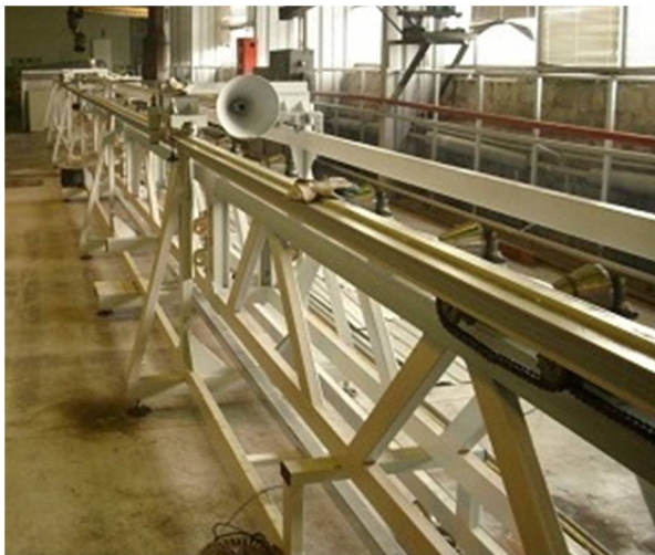
Автоматизированный комплекс АКН-305-В4А для обработки внутренней поверхности остовов нефтяных насосов длиной до 9000 мм перед нанесением защитного покрытия.
